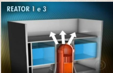
Foi a falta de refrigeração que fez o reator superaquecer. O vapor foi liberado para a atmosfera, misturado com hidrogênio. Foi isso que provocou as explosões.
